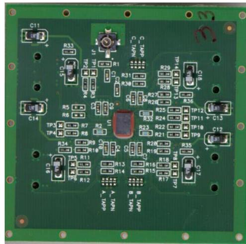
Fig. 7 ASIC test module photo
